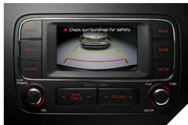
CÁMARA DE RETROCESO INTEGRADA
